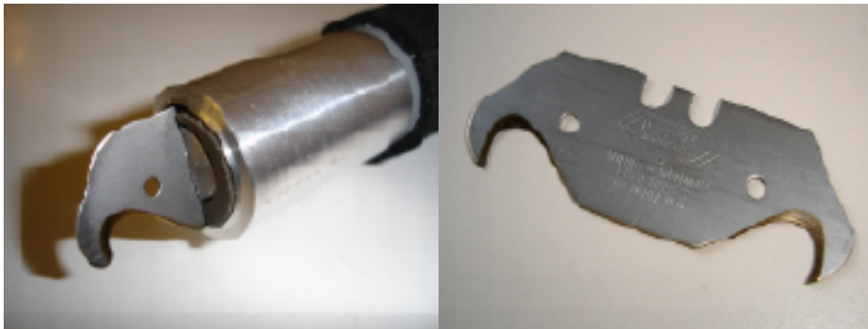
Abb. 3: Hakenklinge am unteren Ende des Fischtötters und unbearbeitete Ersatzklinge (Foto: F.Baici 2004).
