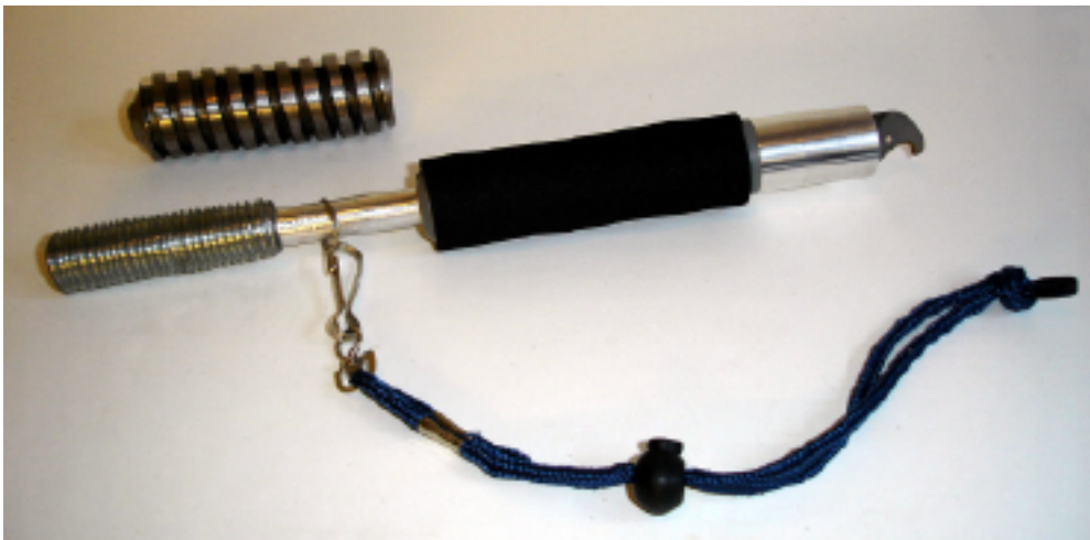
Abb. 2: Prototyp eines neuartigen Fischtötters (Foto: F.Baici 2004).
